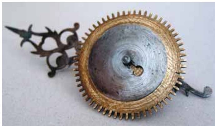
Il. 16b. Detal - wskazówka godzinowa sztywno osadzona na osi ciernie połączonej z kołem zębatym.
